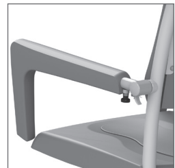
Figura 8. Reposabrazos girado hacia fuera.
