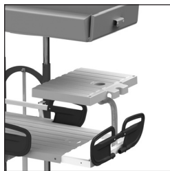
Figura 15 Desmontaje de la placa de apoyo y el colchón.
